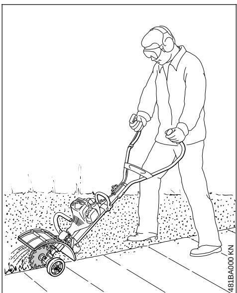
MultiNástroj "Zarovnávač okrajů FC-MM" slouží k ostrohrannému zarovnávání okrajů zazeleněných ploch. S tímto strojem mohou být převezány
