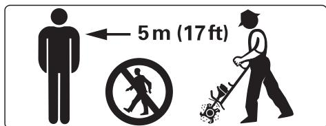
V okruhu 5 m se nesmí zdržovat žádná další osoba – při kontaktu s pracovním nástrojem a v důsledku odmršťovaných předmětů hrozí nebezpečí úrazu! Tento odstup zachovávejte i od věcí (vozidel, oken) – **hrozí hmotné škody! Ani ve vzdálenosti větší než 5 m není možno vyloučit ohrožení.**
